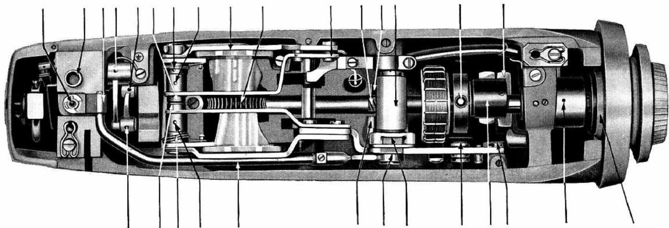
Abb. 2 — Arm der Zickzack-Automatic-Nähmaschine, Armdeckel abgenommen
