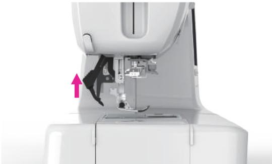
Drücken Sie den Doppeltransport-System-Mechanismus nach oben.
