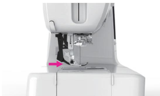
Schwingen Sie den Doppeltransportsystem-Mechanismus nach vorne unter die Rückseite des Nähfußes, bis er einrastet und in abgelenkter Position bleibt.
