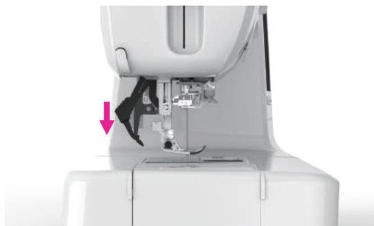
Senken Sie den Doppeltransport-System-Mechanismus langsam ab.
