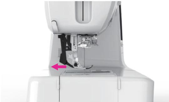
Ziehen Sie den Doppeltransport-System-Mechanismus nach unten und schwingen Sie ihn zum ausschalten nach hinten.
