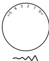
Wenn die Maschine über die Stichbreitenradfunktion verfügt, kann die Nadelposition für Geradstiche mittels der Stichbreiteneinstellung geändert werden. (modellabhängig)
